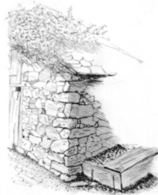
Détail de chaînage d'angle réalisé avec des blocs de pierre bruts ou taillés
